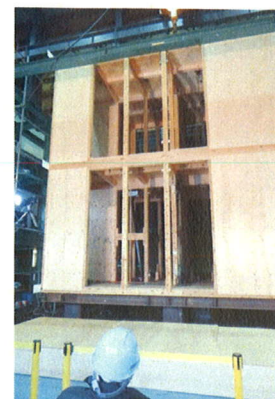
震度7の揺れを発生させ、木造住宅に設置する制震製品の性能を調べた実験装置(宇治市五ヶ庄・京都大防災研究所)
